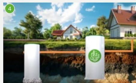
Сброс очищенных вод в фильтрующий колодец самотёком.
