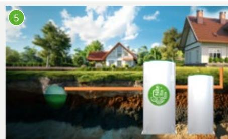
Принудительный забор стоков из приёмного колодца с последующим сбросом в дренажную канаву.
