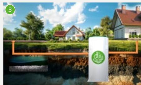
Сброс очищенных вод в дренажное поле фильтрации самотёком.
