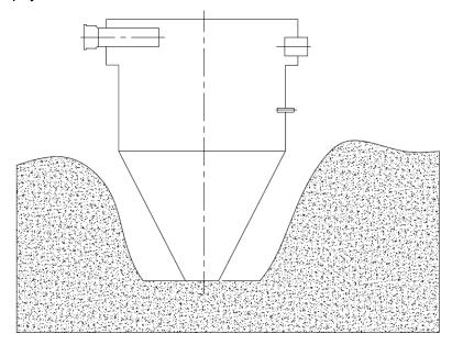
2. Засыпать первый слой песка (20–30 см) Выверить положение корпуса пузырьковым уровнем. Утрамбовать первый слой трамбовками или пролить водой.
